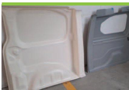
8.2 Verkleidungen die den Umriss der Fahrzeugwände folgen.
