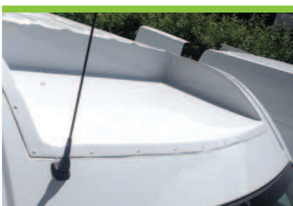
6.28 Dachausschnitt für das Aggregat
