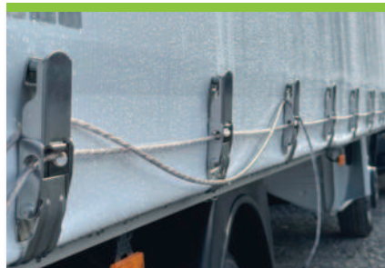
2.5 Vorhangsystem mit Befestigung am Spriegel mit Edelstahlspan- ner
