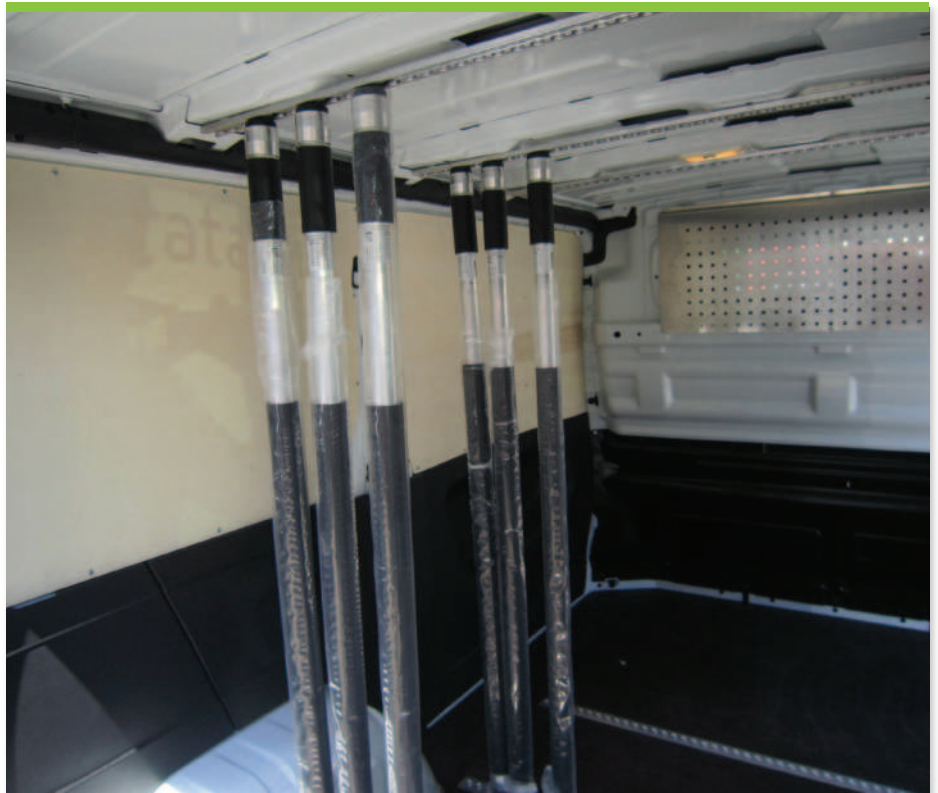
12.2 Absperrstangen als Schranke und Querbalken für Ladungssicherung
