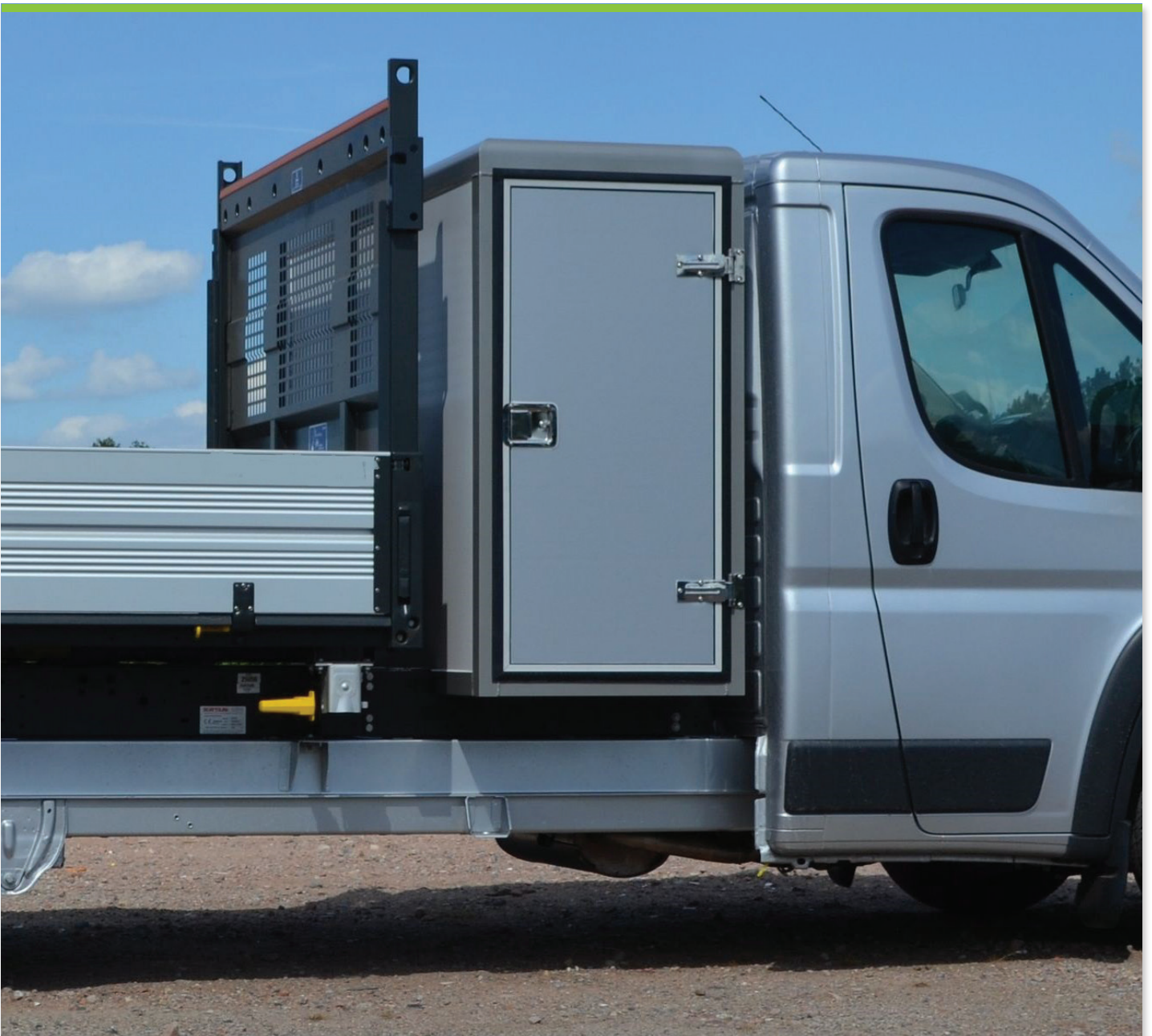
3.19 Metallkasten hinter der Fahrerkabine T=640 x B=2000 x H=800 mm
