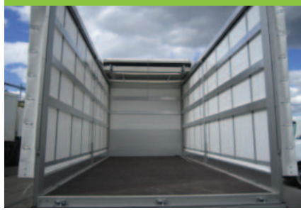
2.20 Aufklappbares Dach (nur in Kombination mit dem Vorhangsystem links und rechts)
