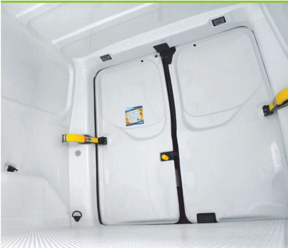
8.4 | Fiberglasverkleidung der Hecktüren
