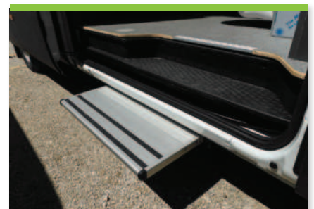
12.6 Fuss- oder elektrisch betätigte Eintrittsstufe (400 bis 1200 mm)
