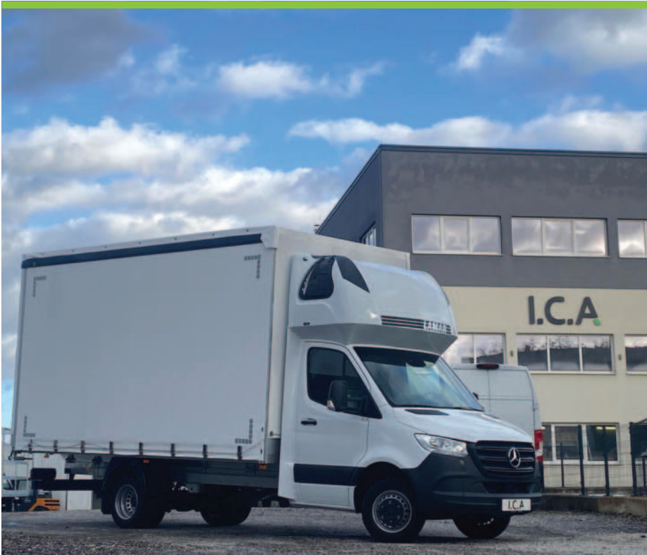
2.13 Pritsche mit Plane, Vorhangsystem, aufklapbares Dach und Schlafkabine
