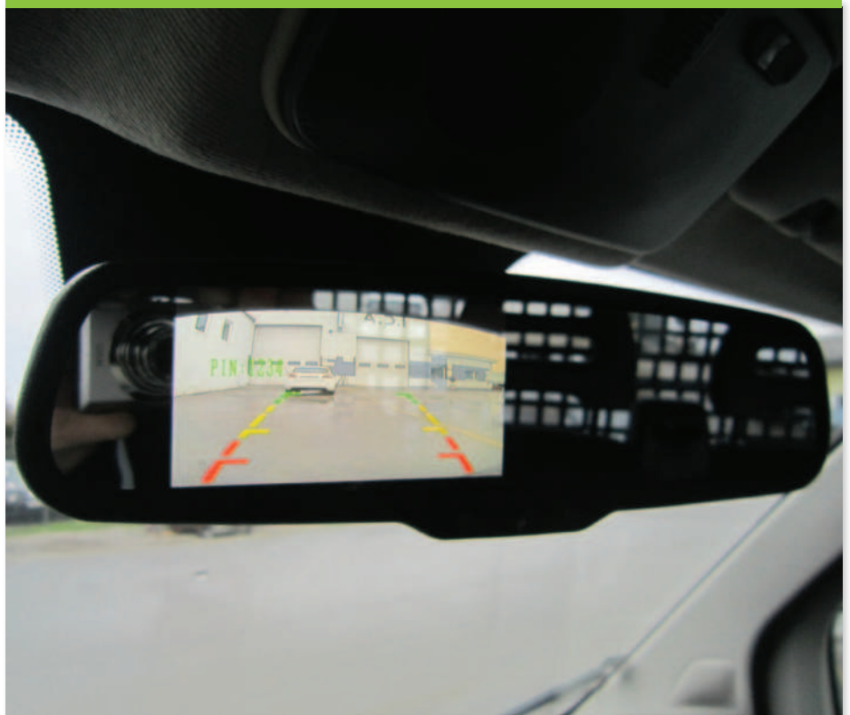
14-9 Einparkhilfe, Monitor im Rückspiegel oder separater Monitor auf dem Armaturenbrett
