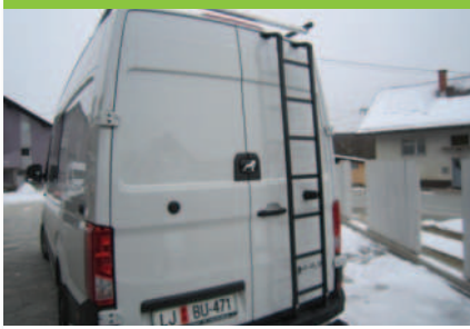
8.4 Leiter für den Zugang auf das Dach (installiert auf die Hecktür)
