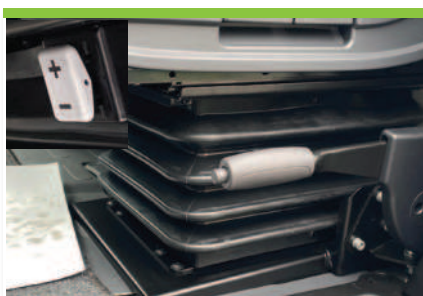
14.28 Luftgefederter Sitz mit Kompressor und Härterregulierung
