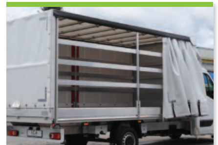
2.3 Vorhangsystem mit schnellöffnendem Rollo hinten
