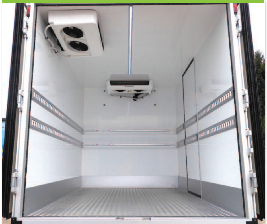
5.2 Fahrzeuge von 5t bis 7,5t, verstärkte Kofferstruktur und Hilfschassis
