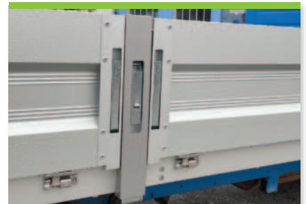
1.6 Zwei separate Seitenbordwände auf einer Seite ab 4000mm Länge
