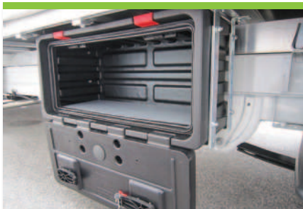
14.16 PVC-Koffer (Breite von 400 bis 1000 mm) mit Halterungen und Einbau
