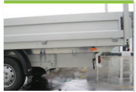
1.3 Chassisverlängerung aus Edelstahl von 150 mm bis 1000 mm (gegen Aufpreis)
