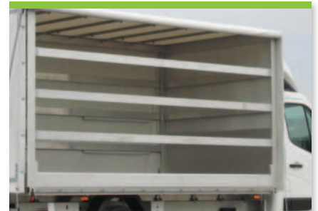
2.9 KONSTRUKTION ohne Seiten- bordwände (alle drei Seiten mit 150 mm französischen Lamellen) + klassische Plane / Befestigung am Spriegel
