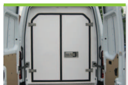
6.9 Zusätzliche Hecktür für den Temperaturbereich -20°C
