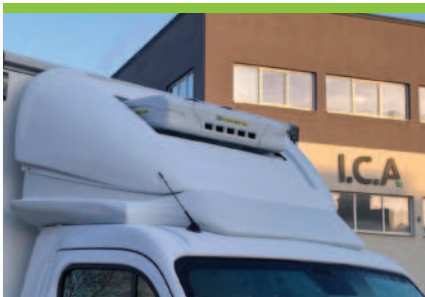
5.3 Frischdienst Kühlkoffer mit der Kühlanlage hinter dem aufklappbaren Dachspoiler
