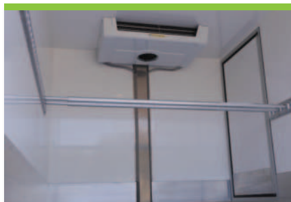
5.7 Absperrstange als Trennwand und Ladungssicherung
