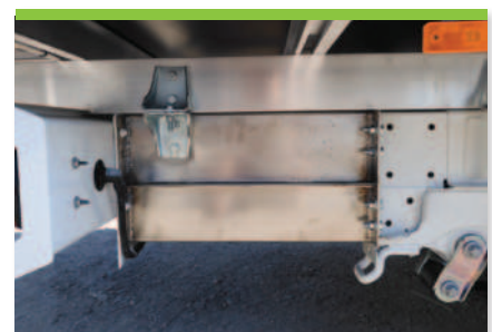
5.23 INOX-Chassisverlängerungen von 150mm bis 1000mm
