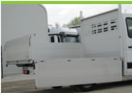
1.4 Erhöhung der Seitenbordwände bis zu 600mm
