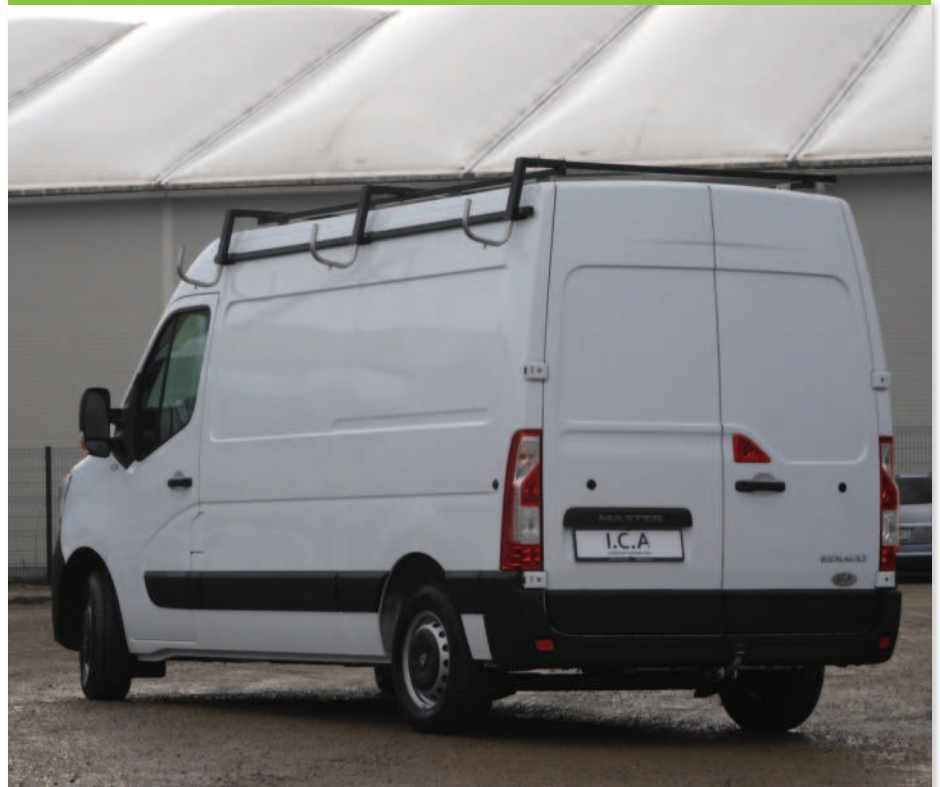
8.5 Haken für Transport langer Gegenstände auf dem Dach
