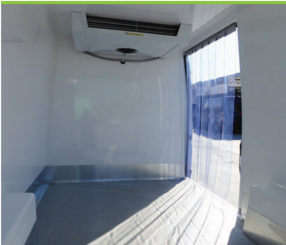
6.10 Seitentür mit PVC Isolierungsvorhang
