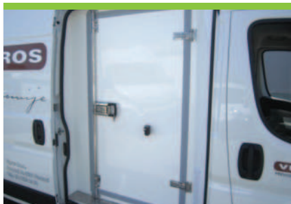
6.8 Zusätzliche Seitentür für den Temperaturbereich -20°C
