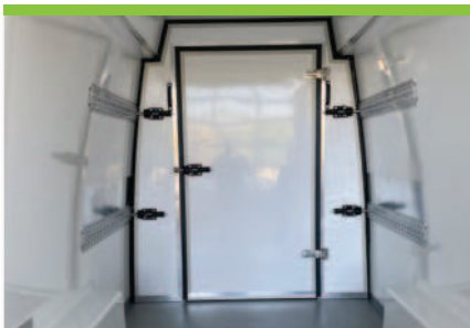
6.7 Verschiebbare Trennwand auf Alu-Schienen mit Tür
