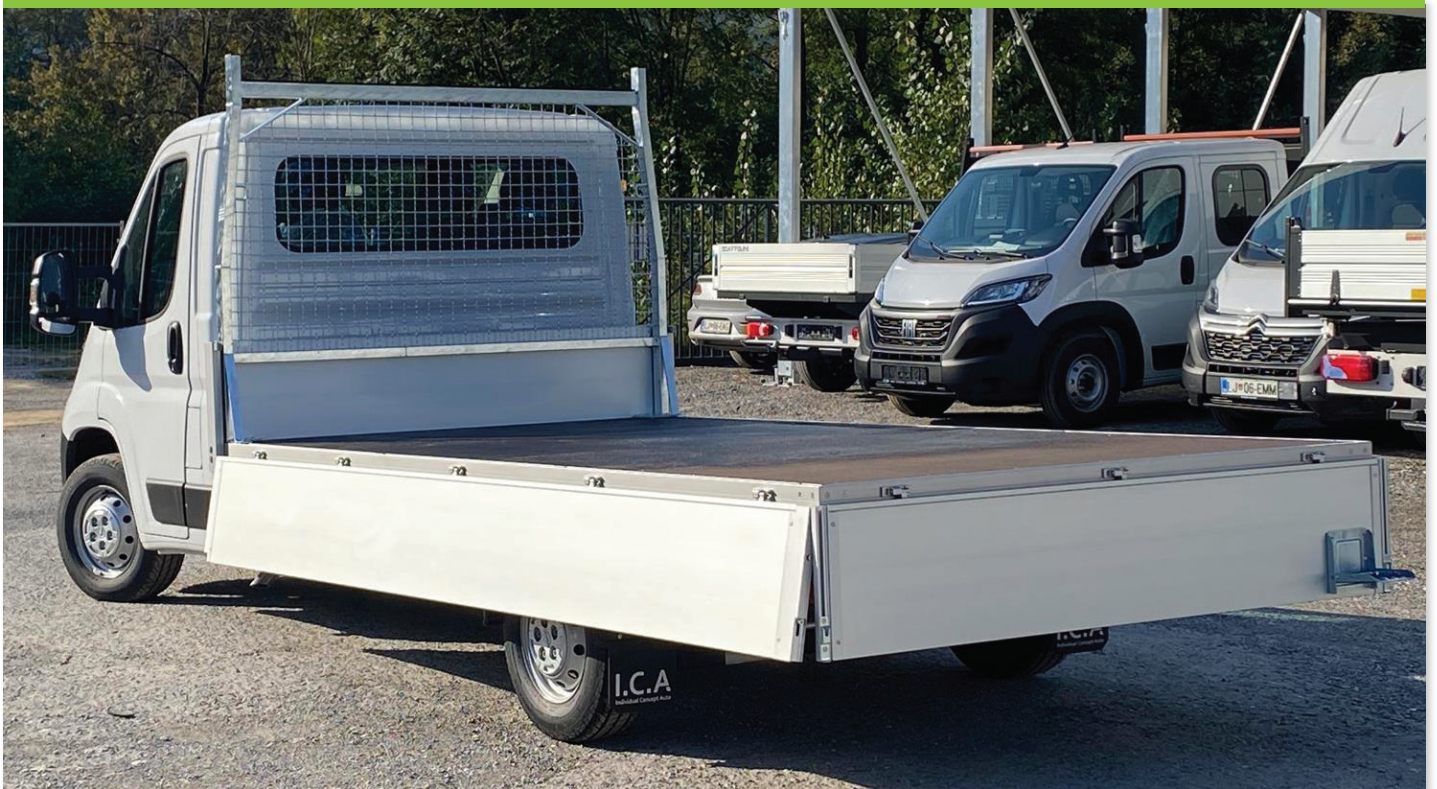
1.17 Allseitige offene I.C.A. Alu Pritsche mit Leiterträger vorne
