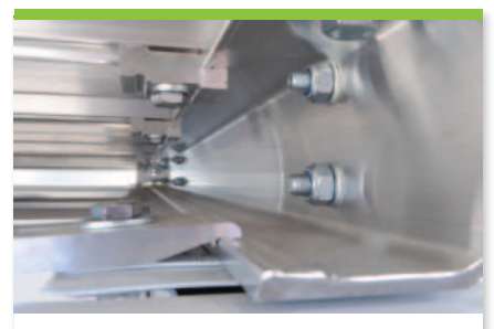
2.21 Hilfsschassis aus eloxiertem Alu, (wie auch Bordwände) womit das spätere Oxidieren verhindert wird
