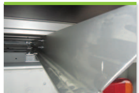
4-10 Hilfchassis aus eloxiertem Alu womit das spätere Oxidieren verhindert wird
