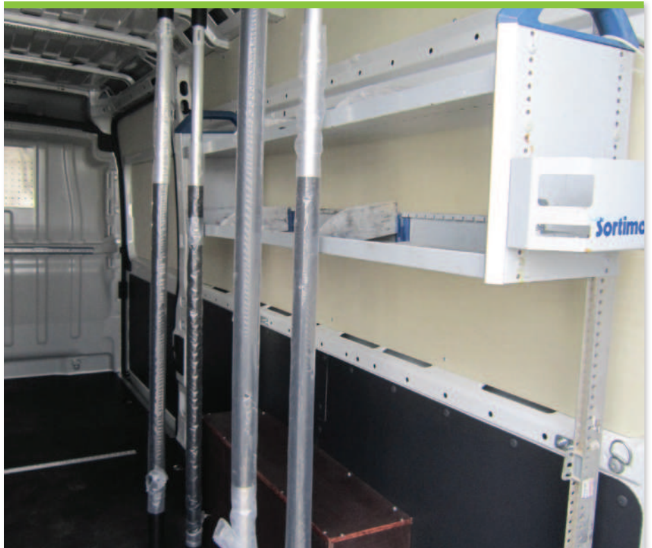
9.2 Absperrrange für die Trennung und Sicherung der Ladung
