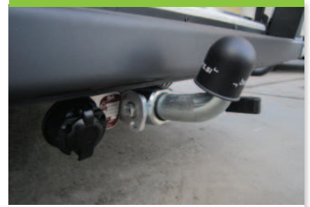
14-6 Anhängerkupplung für Kastenwagen oder Chassis, mit oder ohne verlängerung, (hochbelastbar) mit 13-poliger elektrischer Verkabelung
