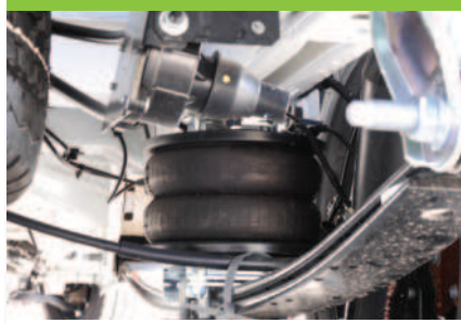
14-5 VB DRIVERITE 8" Premium, regulierbar vom Fahrgastraum (L/R), ein Manometer und ein separater Absenktasten für jede Federung mit Homologation
