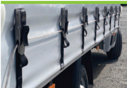
2.4 Vorhangsystem mit Befestigung am Spriegel
