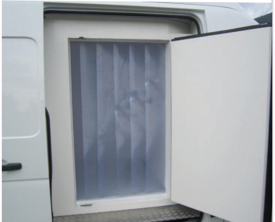
6.22 PVC Isolierungsvorhang in der Seitentür
