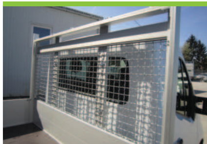
1.5 Zusätzliche Gitterrostverstärkung des Leiterträgers
