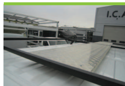
8.3 Dachtrittgalerie (Aluminium oder Stahl pulverlackiert)
