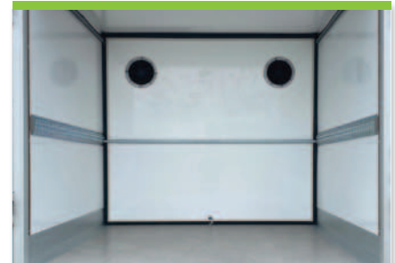
5.20 Lüftungssystem mit separater Steuerung für die Partition
