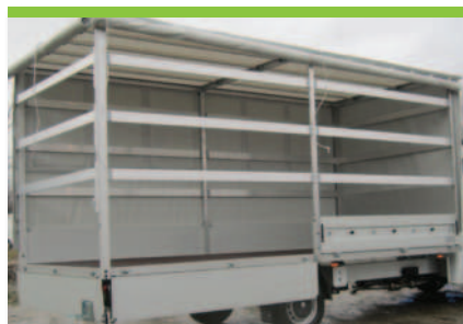
2.8 Plane mit schnellöffnenden Rol- los (links, rechts und hinten)
