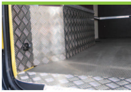
14-11 Rippenblechplatten zum Schutz der Ladefläche und Seitenwände in der Höhe von 400 mm
