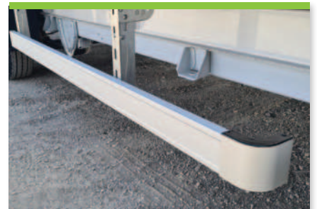
2.15 Seitlicher Anfahrerschutzträger (links und rechts) + seitlicher Anfahrerschutz (links und rechts)
