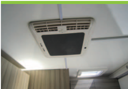
14.25 Dachklimaanlage Sinclair 17.26, 2,5 kW oder 3,5 kW
