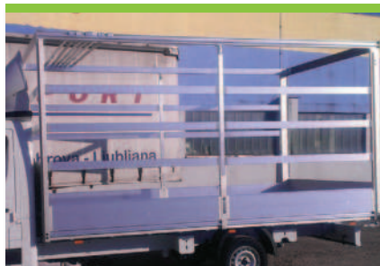
2.7 Erhöhte Seitenbordwände auf 600 mm (Standard ist 400 mm)
