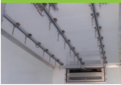
5.16 3-Schienen-System mit Verstärkungsgitter + Edelstahlhaken.
