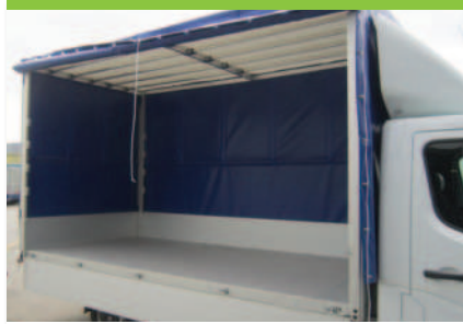
2.2 Schnellöffnungsrollo, Befestigung am Spriegel oder Seitenringen
