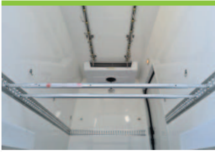
6.4 Teleskopstangen für Ladungsicherung, Befestigung auf Alu-Ankerschienen
