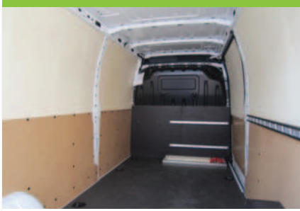
14-4 Innere 6 mm Holzverkleidung (Birke) entsprechend der Länge des Aufbaus von 2500 bis 4800 mm
