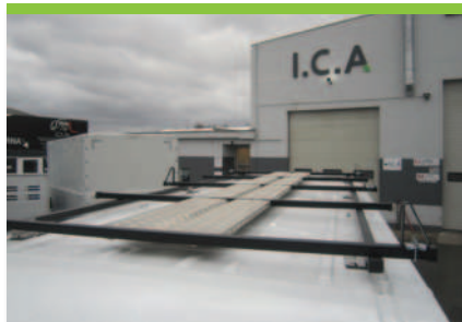
8.6 Dachgepäckträger (Aluminium oder Stahl pulverlackiert)
