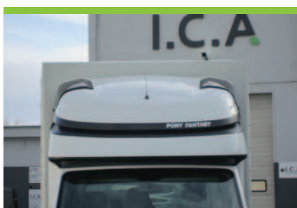
14.3 Premium AERO Schlafkabine + Seitenflügel (von 740 bis 1000 mm)
