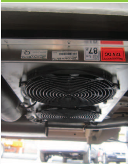
7.2 Kühlanlage unter dem Boden (Kastenwagen oder Kammer)
