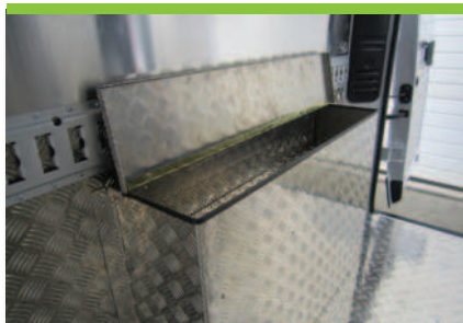
14.17 Kasten aus geripptem Blech mit den Abmessungen 1900 mm x 600 mm x 600 mm, mit einer Verschlussdeckel und einem Schloss
