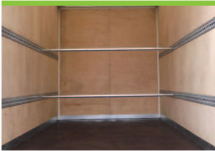
4-2 Runde Absperrstange für Ladungssicherung (Befestigung auf seitliche Ankerschienen)
